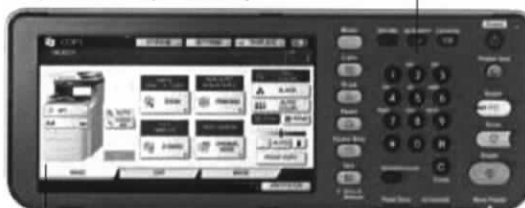
Panel touch screen de 9 polegadas: facilita a navegação, otimiza a produtividade e permite o acesso à soluções baseadas na Web
