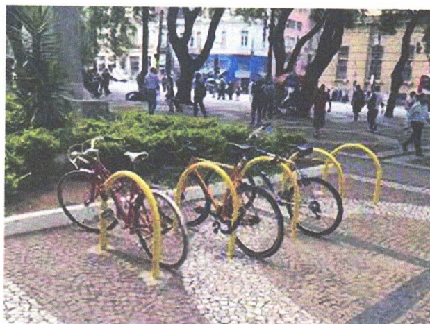
Figura 9-3: Modelo de paraciclo em formato "U" invertido
